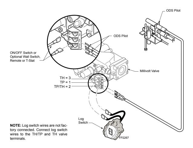
Figure 14 -Wiring Diagram
